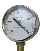
Manometro o manovuotometro senza flangia, attacco radiale 3/8" – 1/2", scale comprese tra –76 mm e +60 bar, viene costruito con quadrante diam. 80-100-160 mm, cassa inox a secco od in bagno di glicerina
