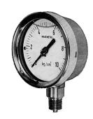
Manometro o manovuotometro con flangia, attacco radiale 3/8" – ½", scale comprese tra –76 mm e +60 bar, viene costruito con quadrante diam. 80-100-160 mm, cassa stagna inox a secco od in bagno di glicerina
